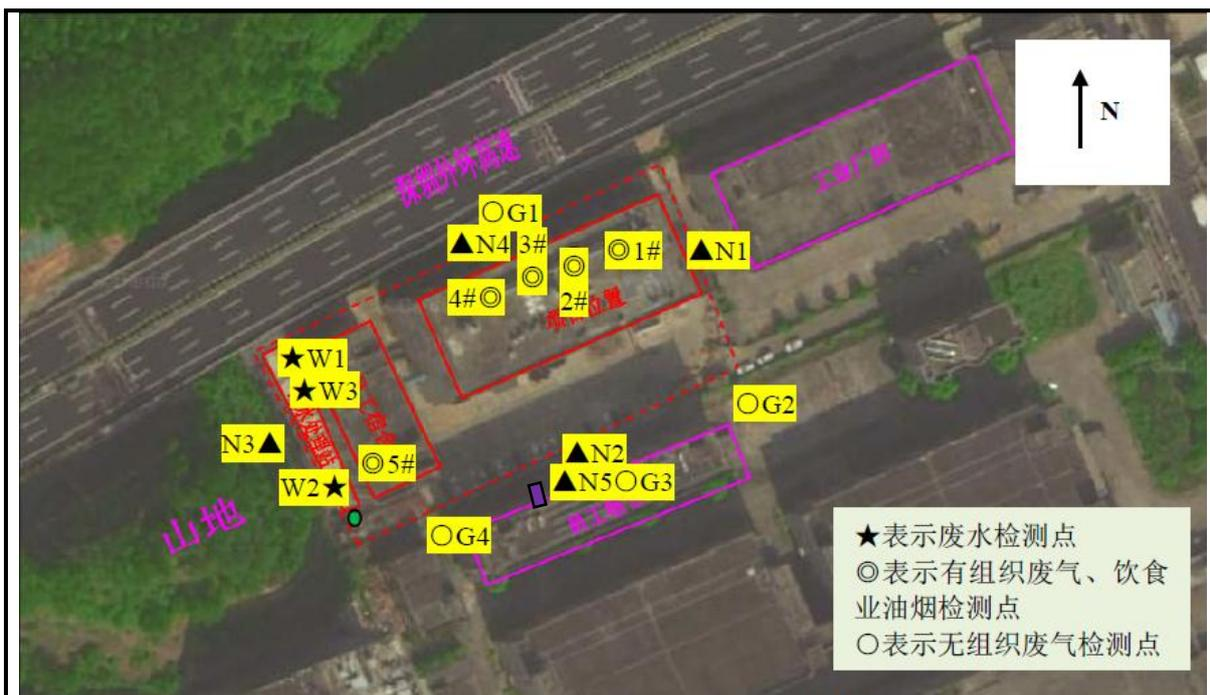
图 3-1 废水、废气、噪声环境监测点布置图
