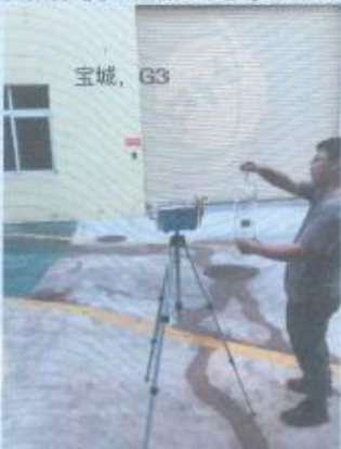
厂界废气无组织排放下风向检测点 G3
