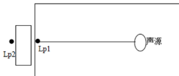
图 4-2 室内声源等效为室外声源图例
