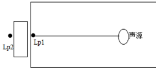
图 4-3 室内声源等效为室外声源图例
