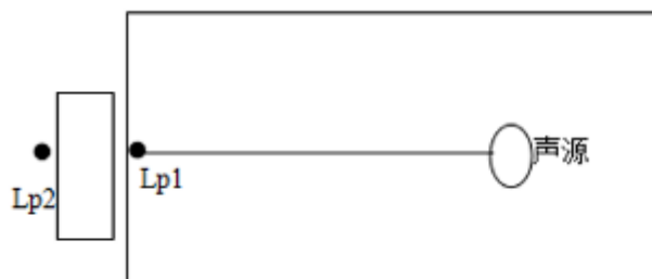
图 4-4 室内声源等效为室外声源图例
