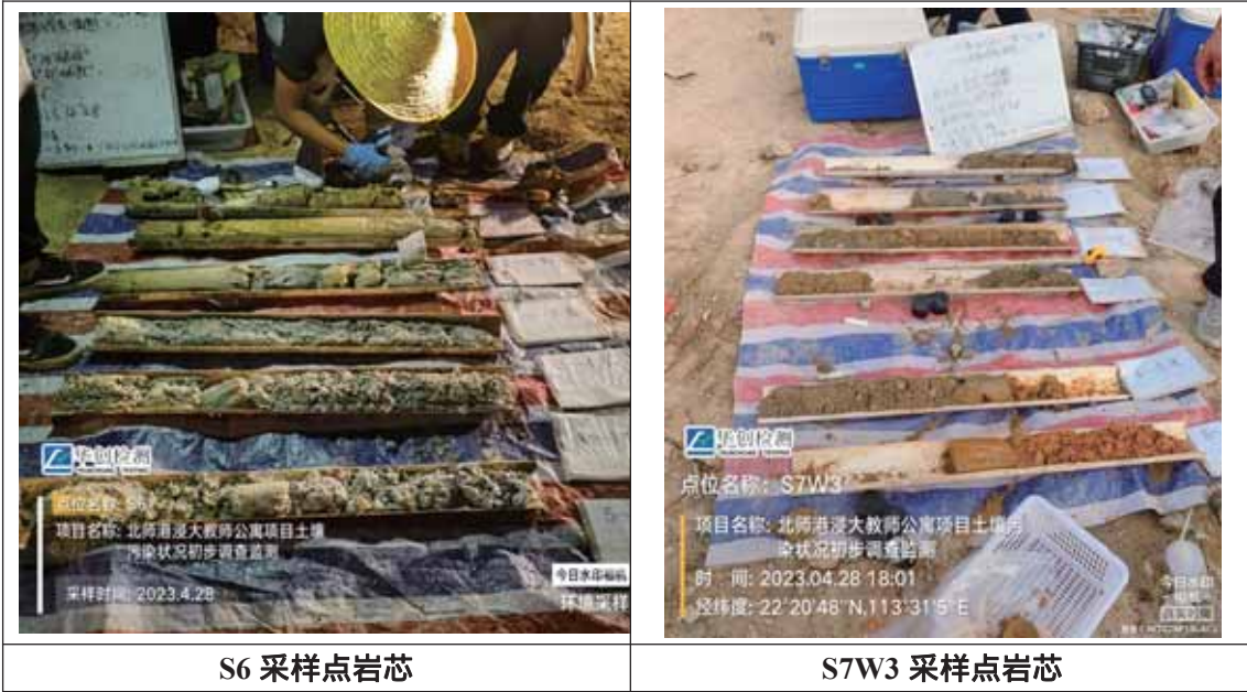
图 4.2-1 土壤样品现场采样及保存情况
