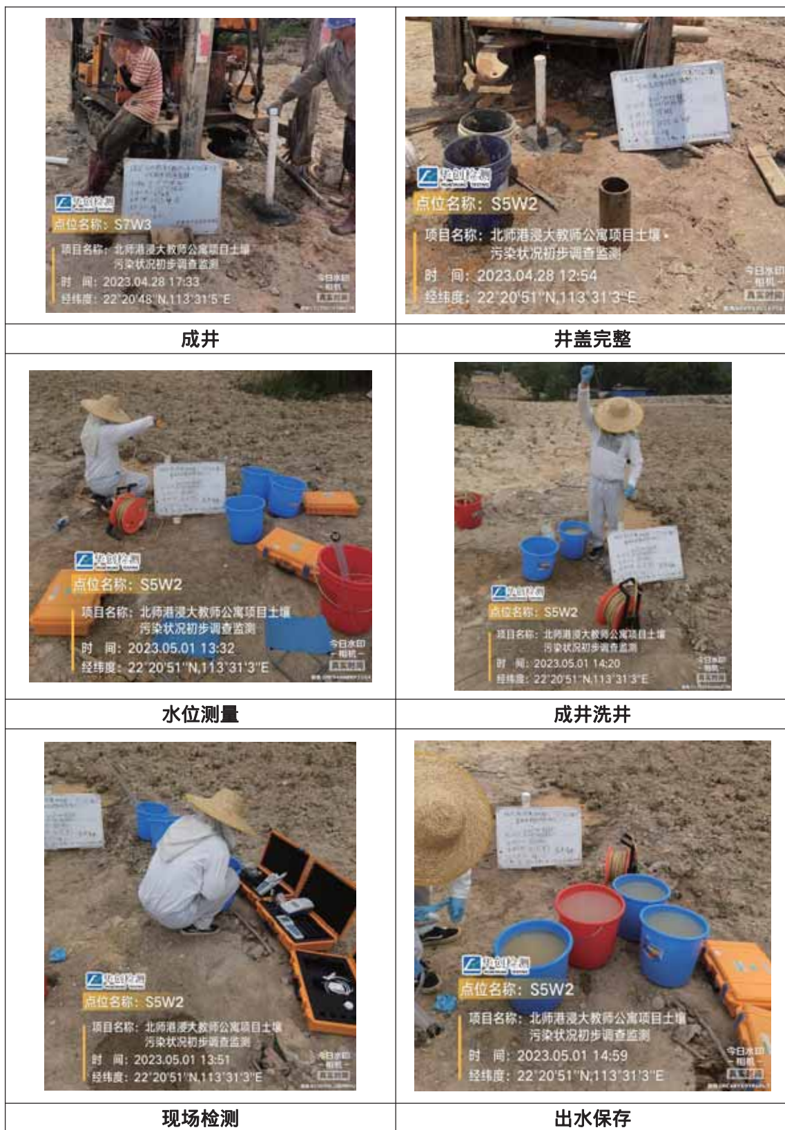
图 4.2-3 地下水监测井建井和洗井
