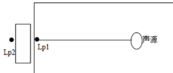
图 4-3 室内声源等效为室外声源图例
