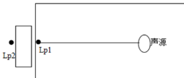
图 4-1 室内声源等效为室外声源图例
