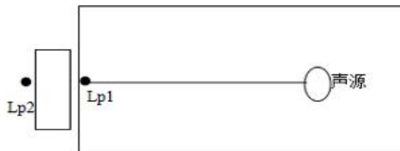
图 4-1 室内声源等效为室外声源图例
